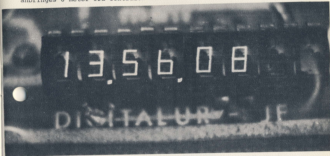
Billedet viser selve tallene i display'ene, man kan på denne forstørrelse lige skimte de små guldtråde som forbinder de forskellige segmenter. Hver segment består af fire små lysdioder, sammensat på en meget fin måde. De anvendte lysdioder har så lavt strømforbrug, at det er muligt at styre tallenes segmenter direkte fra den integrerede kreds.
